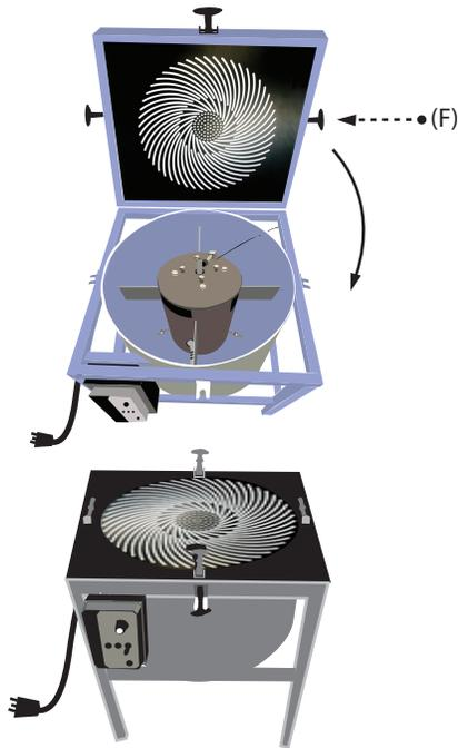
Fermer le couvercle à l'aide des 3 attaches de caoutchouc (F). Placer la machine sur le dos et ouvrir le couvercle.
