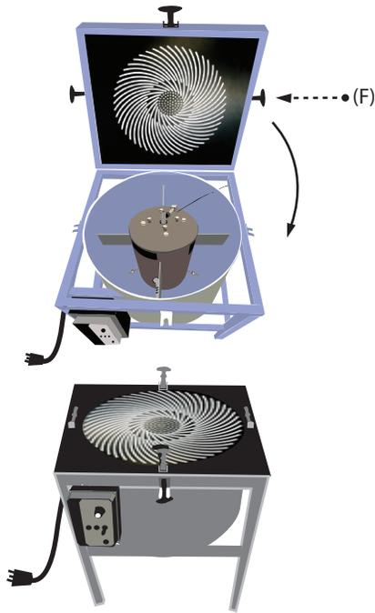
Cierre la tapa usando los 3 sujetadores de goma (F). Apoye la máquina en su parte posterior y abra la tapa.
