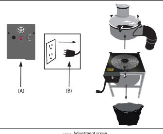
Apague la máquina con el interruptor ON-OFF (A) en el panel de control y desconecte el cable de alimentación (B) del toma tierra. Retire la bolsa usando las tiras de velcro en la parte superior y retire el aro circular de aluminio y estructura plástica usando los clips de goma.
