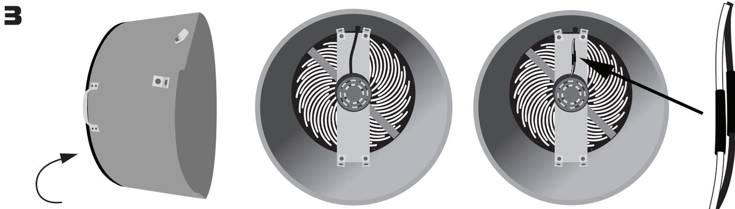
Coloque la máquina en su parte trasera con la parte inferior de la máquina hacia usted. Asegúrate de que la placa intermedia donde va el motor esté en posición vertical, con el enchufe eléctrico en la parte superior, esa sería la forma ideal de trabajar. Verás que el cable interior está cubierto por una protección plástica con una "atadura" al final para mantenerlo en su lugar, corta la "atadura" y quita la protección plástica con las manos.
